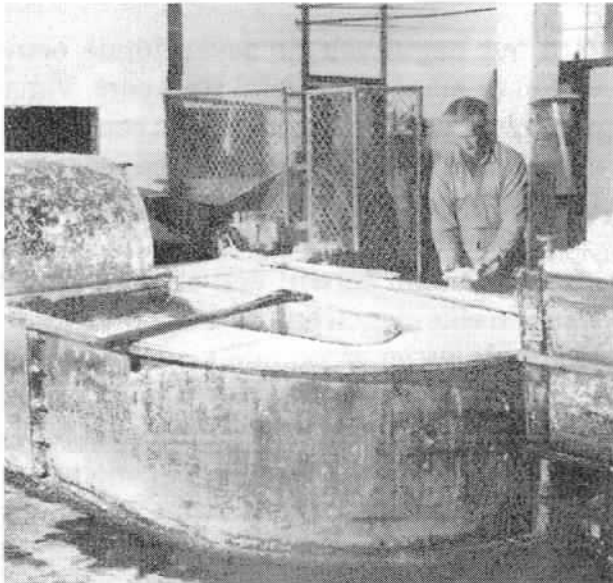
Een Hollander, een van de laatste overgebleven apparaten van dit type in de werkplaats van G. Schut en Zonen.
